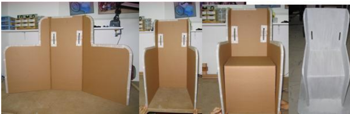
Figura 2. Algumas das etapas na confecção da cadeira de posicionamento com uso de placas de papelão.
